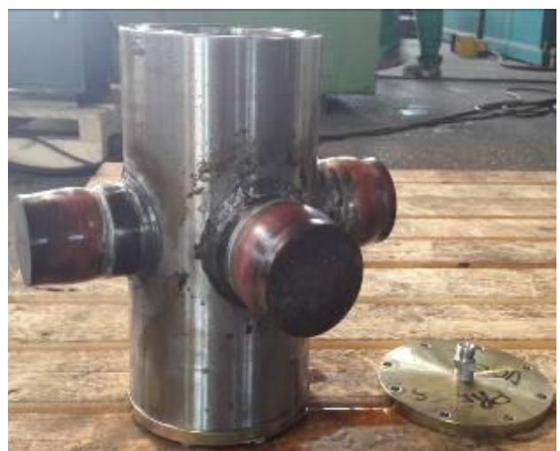
Fig. 4 Valvola Mod. 300 dopo prova idrostatica
