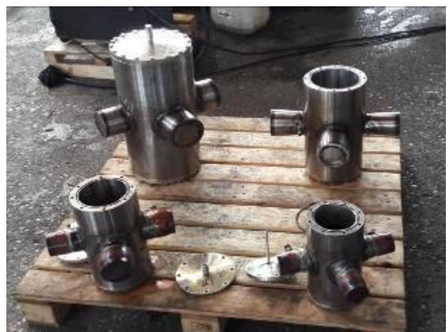
Fig. 2 Vista dall'alto dei 4 modelli di valvola dopo le prove
