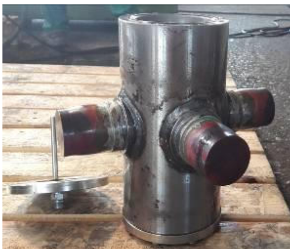
Fig. 3 Valvola Mod. 200 dopo prova idrostatica
