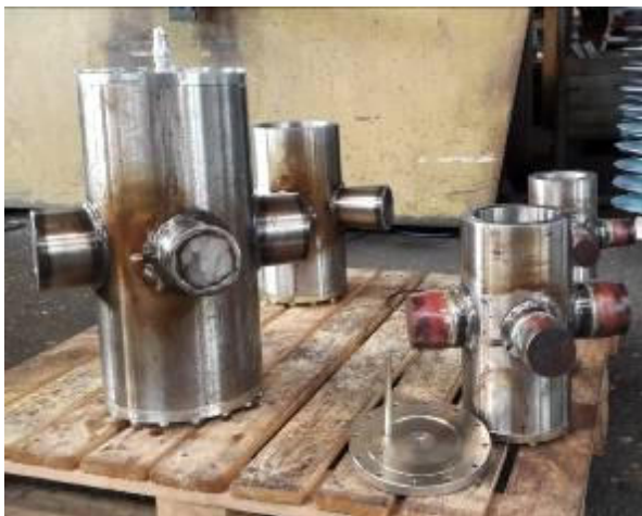
Fig. 1 Dettaglio dei 4 modelli di valvola dopo le prove
